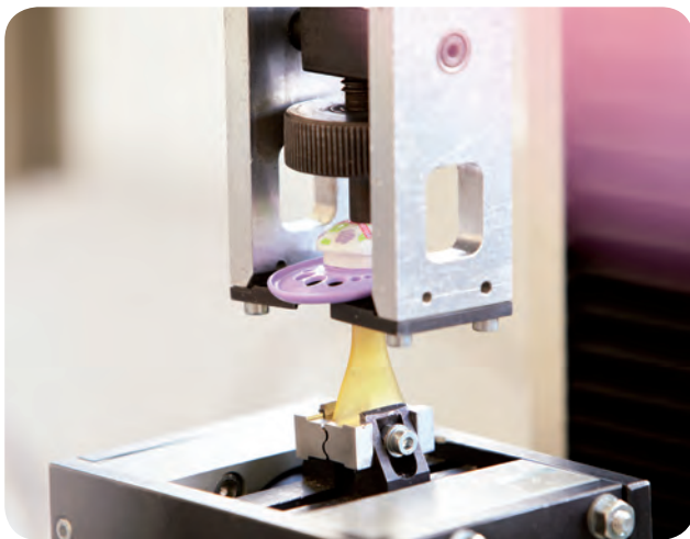
Qualitätsprüfung: Zugfestigkeit MAM Schnuller
