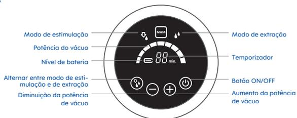
Ligue o Tira Leite pressionando . O processo de extração em 2 fases começa com o modo de estimulação, o qual produz um ritmo curto e rápido de sucção até que o seu leite começa a fluir. O Tira Leite começará, por definição, no nível 1 do modo de estimulação. Existem 9 níveis diferentes de força de sucção, que podem ser ajustados pressionando .
